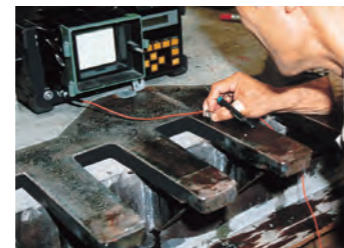
疲労試験完了後の超音波探傷試験
