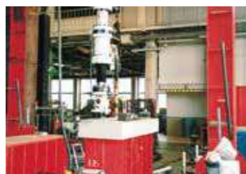
供試体を試験装置に取付け
