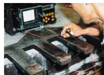
疲労試験完了後の超音波探傷試験
